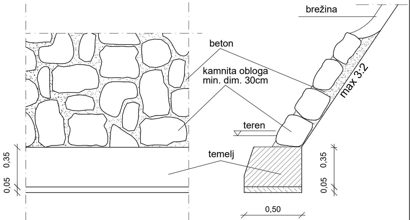
OPOMBA: Za zavarovanje brežin se uporabi lomljenec iz karbonatne kamenine.
